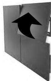
Реже встречается **крепление с полным выдвижением** панелей. Данный тип крепления целесообразно использовать при планировке больших видеостен, так как предоставляет оперативный и полный доступ к задней стенке любой панели.
