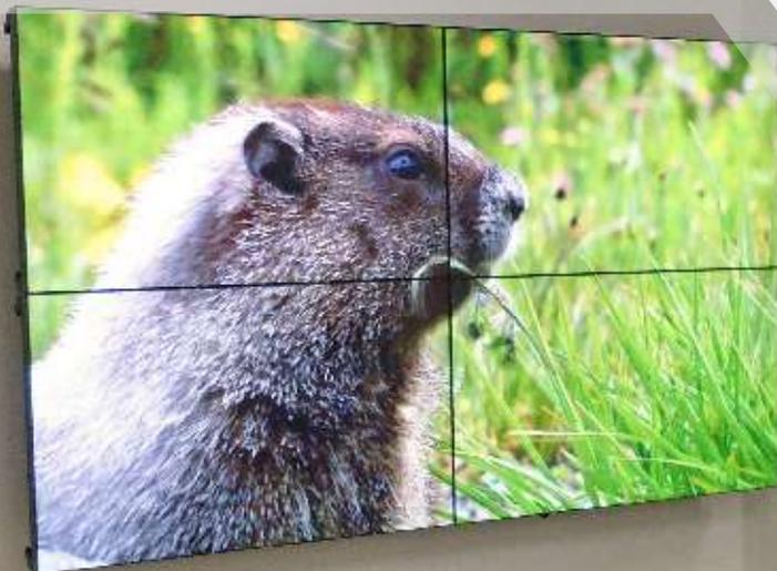
**Видеостена zFlex**, установленная в офисном помещении лаборатории наноплазмоники, позволяет сотрудникам удалённо наблюдать за экспериментами, проходящими в "чистой комнате". Дополнительно установлен контроллер zFlex под управлением Windows 8, что позволяет в 4 раза повысить информационную ёмкость экрана, и сделать его многофункциональным. В частности, видеостену можно использовать для проведения презентаций, или показа фото- и видеоматериалов.
